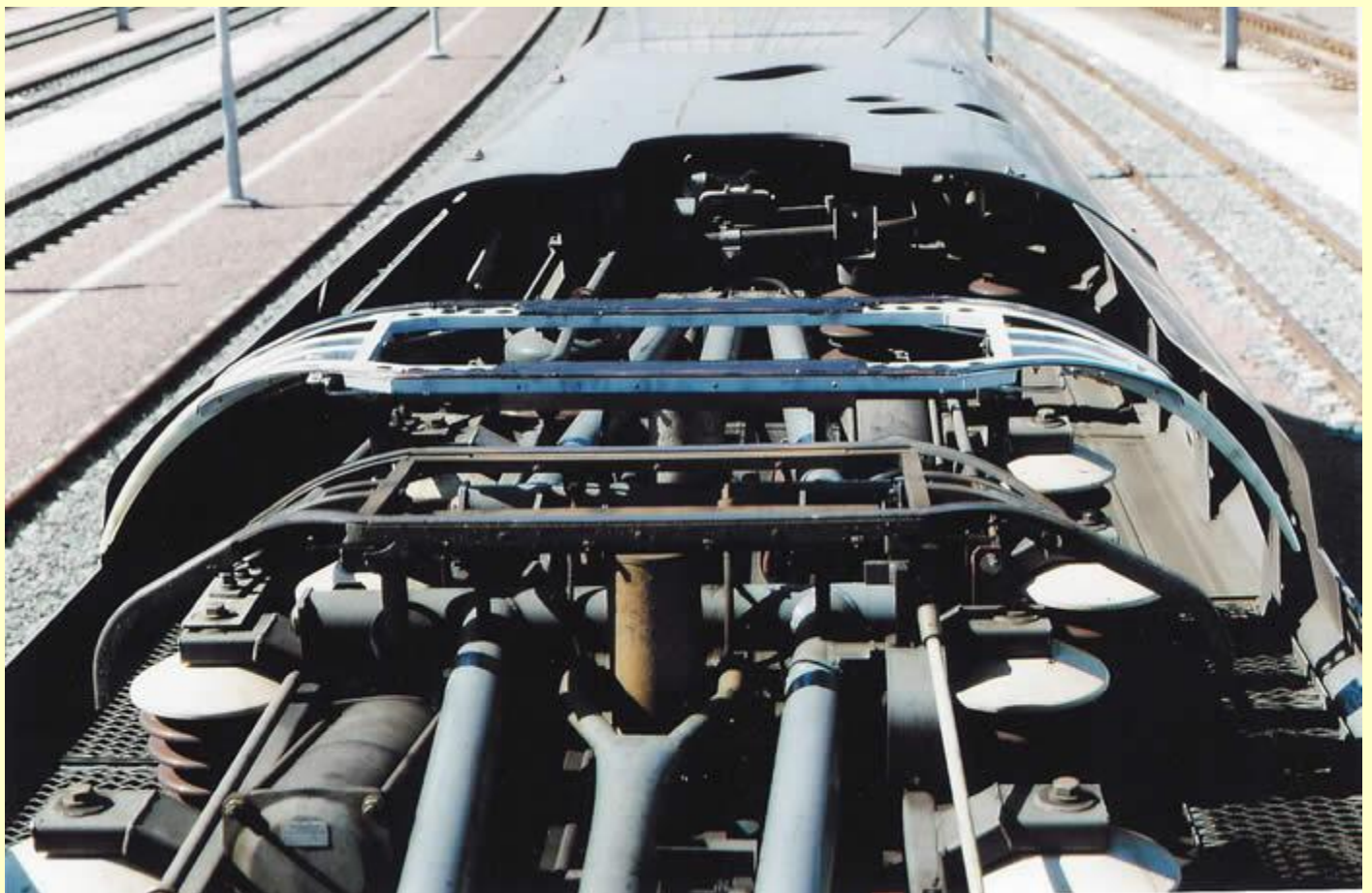
vue sur les pantographes abaissés premier plan le GPU pour le 25 000V, au second plan le GPU pour le 1500V.
