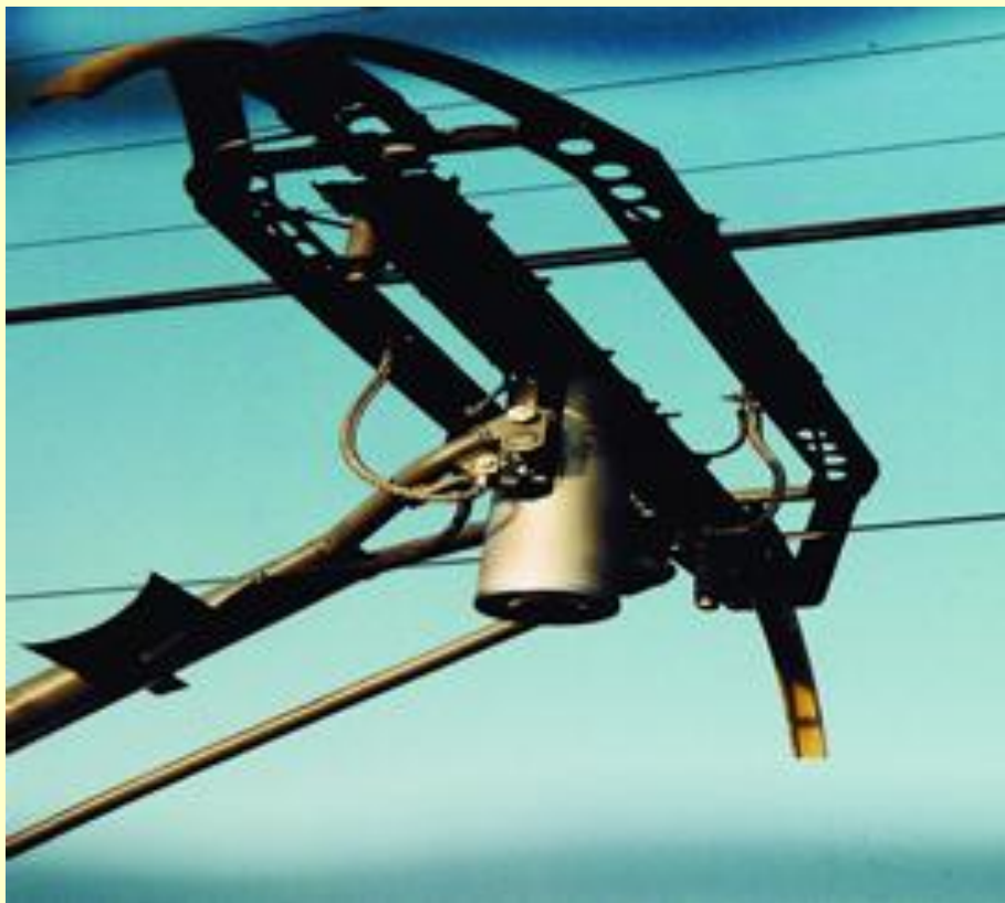
Pantographe Grand Plongeur GPU
