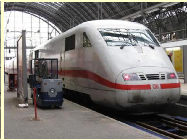
Le nez de la motrice ICE 1, la trappe sur le nez est constitué d'un seul morceau indissociable.
