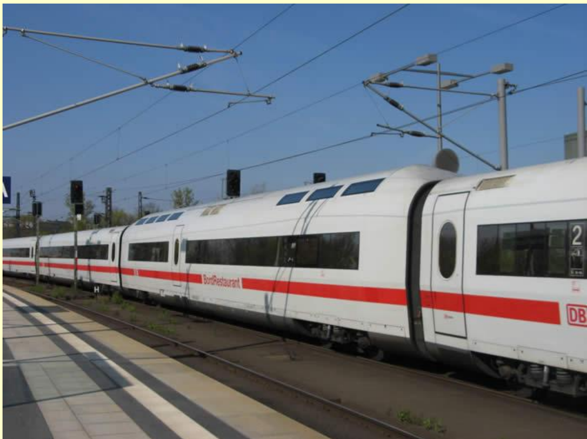
Voiture restaurant d'une rame ICE 1, elle se caractérise, par la hauteur de son toit qui domine les autres voitures.
